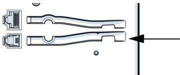
Stecken Sie den Stecker des **langen** geraden Hörerkabelendes in die entsprechende Buchse
