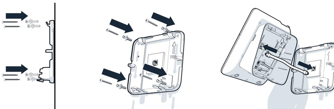
Positionieren Sie die Wandhalterung an der Wand und kennzeichnen Sie die Bohrlöcher. Bohren Sie die Löcher. Setzen Sie passende Dübel ein. Stecken Sie das Netzwerkkabel in die entsprechende Buchse
