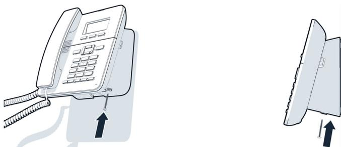
Als letztes setzen Sie bitte die **lange** Sicherungsschraube am unteren Ende des Adapters ein. Damit verschrauben Sie beide Rahmen.
