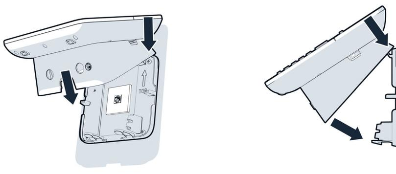
Setzen Sie Ihr Telefon mit oberem Ende des Adapters an den Wandhalter-Rahmen an. Schwenken Sie das Telefon nach unten und rasten es ein.
